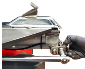
Sistema de bloqueo ajustable (mayor capacidad de bloqueo 10" ÷ 27") Sistema de fixação ajustável (capacidade de fixação aumentada 10" ÷ 27")
